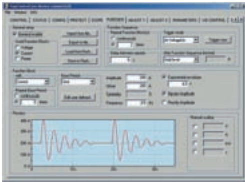
Optionaler integrierter Funktionsgenerator TopCon TFE Bedienoberfläche in TopControl
