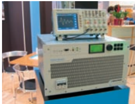
Ausgangsspannung: Exponentiell abklingende Amplitude, generiert durch integrierten Funktionsgenerator TopCon TFE
